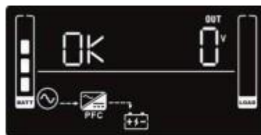
Рис.1 Отображение режима ожидания на дисплее ИБП SRT
