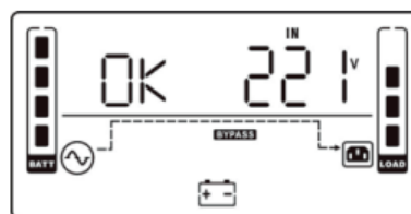
Рис.2 Отображение режима байпаса на дисплее ИБП SRV
